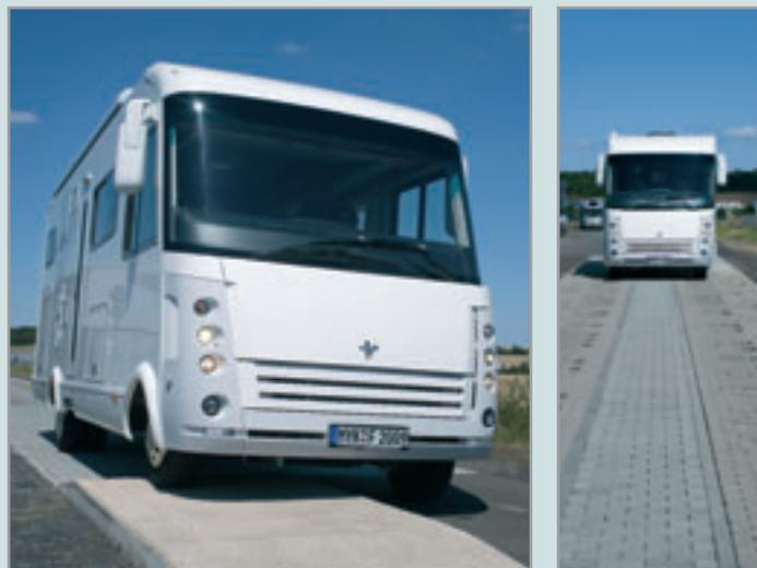
Terminato il processo di produzione, ogni autocaravan passa per la nostra pista di prova di casa ed un impianto di irrigazione prima di essere consegnato al cliente. I veicoli vanno su tratti di pista difficili a rivestimenti diversi per mettere a prova la sicurezza ed il comportamento di guida (frenata, accelerazione, silenziosità di marcia) del telaio e della carrozzeria. La pista è composta come segue:
