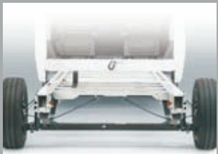
Breitspurfahrwerk (höhere Fahrstabilität und ein großzügigeres Raumangebot durch weit auseinander liegende Radhäuser)
