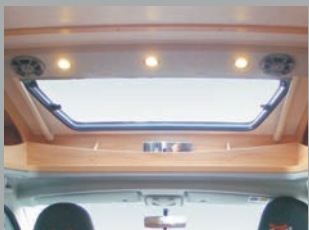
Soundbar mit Lautsprechern und 3-fach LED Beleuchtung im Dachbereich Front.
