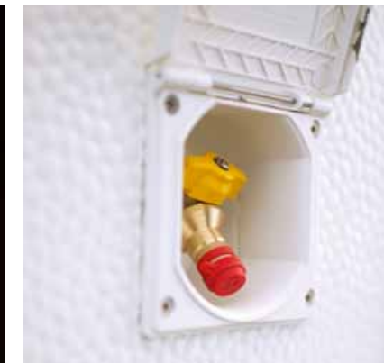
Utvändigt gasoluttag på sidovägg
