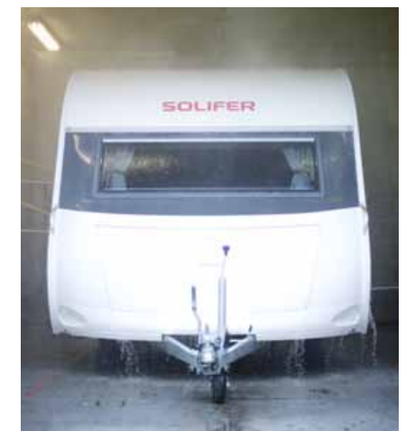
36.000 liter vatten spolar över vagnen under en timmes tid i vår klimatkammare.
