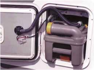
SOG-Toilettenentlüftung Aération toilettes SOG
