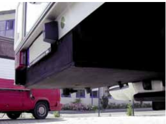
Abwassertank, isoliert und beheizt Réservoir pour eaux usées, isolé et chauffé
