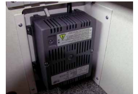
In Luxus-Ausstattung enthalten: AGM-Batterie 95 Ah mit Trennrelais und automatischem Ladegerät (Zwangsoption bei Kompressorkühlbox). Gewicht: 22 kg
