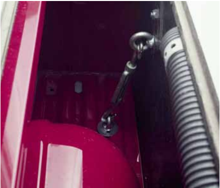
Befestigung der Kabine mit Spannsset oder Schraubgewinde an vier Halteteilen auf der Ladefläche
