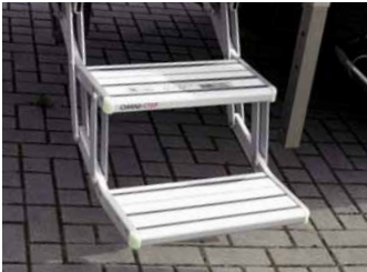
elektrische Einstiegsstufe, 2-stufig, 12 V Marchepied électrique, 2 marches, 12 V
