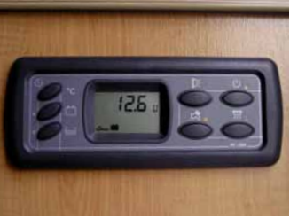
digitales Bord-Control-System mit Aussen- und Innentemperatur-Anzeige, Uhrzeit und optionalem Aussenlicht-Schalter Système de contrôle de bord numérique avec affichage de la température extérieure et intérieure, minuterie et interrupteur optionnel pour l'éclairage extérieur
