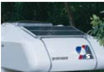
Solaranlage, bestehend aus einem 75-WModul, Ladestromregler
