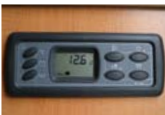
Digitales Bord-Control-System mit Außen- und Innentemperatur-Anzeige, Zeituhr und optionalem Außenlicht-Schalter
