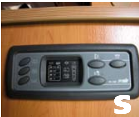
Bord-Control-System für Frisch- / Abwassertank, Aufbau- / Fahrzeugbatterie, 12-V-Hauptschalter und Wasserpumpenschalter. (nicht bei TRAIL / BOX 200)
