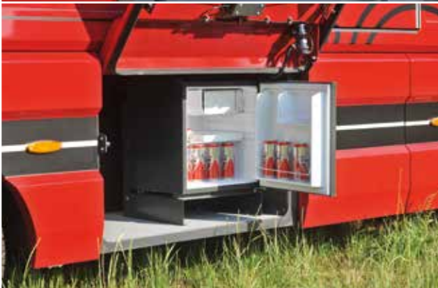
Zusätzlicher Kühlschrank im Außenstaufach.
