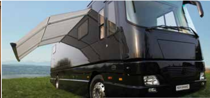
Flächenbündig versenkbare Haushaltsmarkise (auch mit Beleuchtung), im vorderen Teil zur größeren Schattengewinnung abgewinkelt, Tuch frei wählbar.
