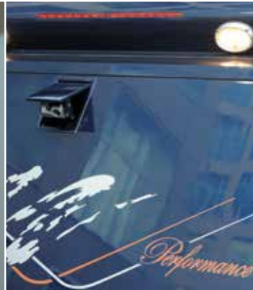
Rückfahrkamera mit Doppeloptik für Nah- und Fernbereich.
