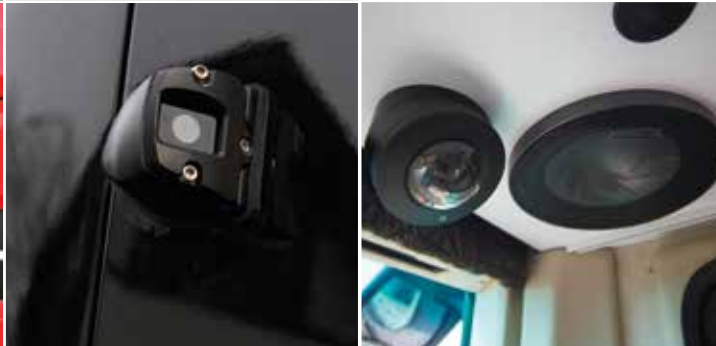
Vier Außenkameras als Rangierhilfe und zur Überwachung. Die Bilder können einzeln oder insgesamt auf dem Monitor sichtbar gemacht werden. Eine weitere Kamera zur Innenraumüberwachung.
